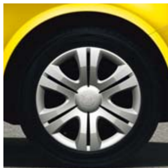
Колесные колпаки Satellite (5J0 071 435A) - комплект из четырех пластиковых колпаков для стальных колесных дисков 6J x 15"
