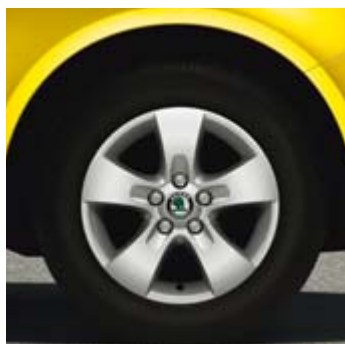
Легкосплавный колесный диск Atik (CCH 700 003) - 6J x 14" - шины 185/60 R14
