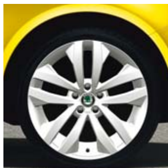
Легкосплавный колесный диск Gigaro (5J0 071 496C)*, белый - 7J x 17" - шины 205/40 R17
