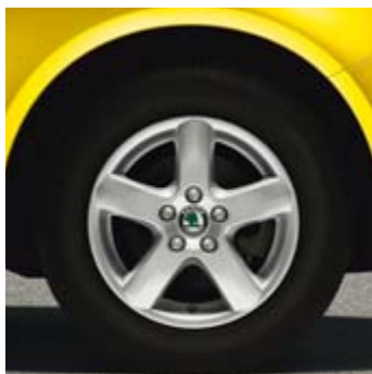
Легкосплавный колесный диск Fun (CCS 700 001) - 5J x 14" - шины 165/70 R14
